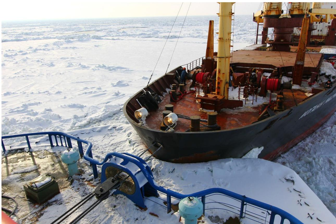
Рисунок 1 – Расположение судна в кормовом вырезе (кринолине) ледокола при буксировке «на усах». Фото: © АО «ЦНИИМФ», 2022
