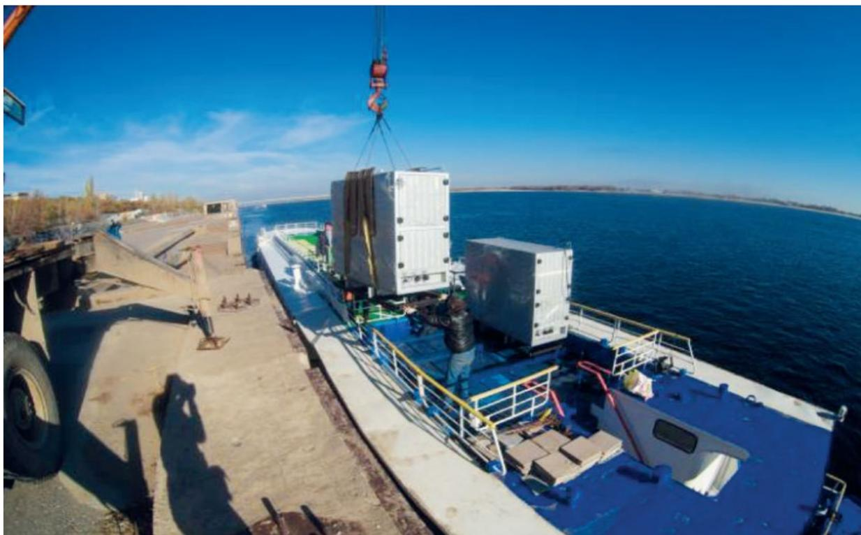
Рисунок 2 – Погрузка быстросъемных криогенных модулей со сжиженным природным газом [4]
