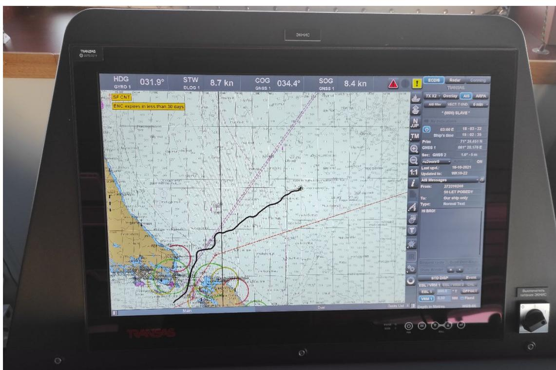
Рисунок 2 – Дисплей навигационной системы Transas NaviSailor-4000.
