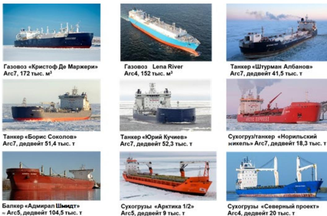
Рисунок 2 – Действующие типы арктических судов, работающие в акватории СМП
