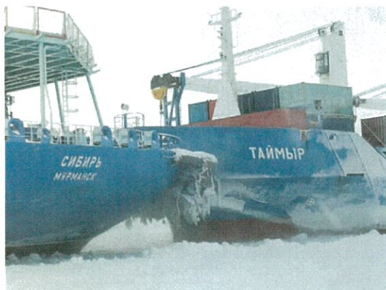
Рисунок 3 Натурные испытания буксировки судов по Северному морскому пути (СМП)
